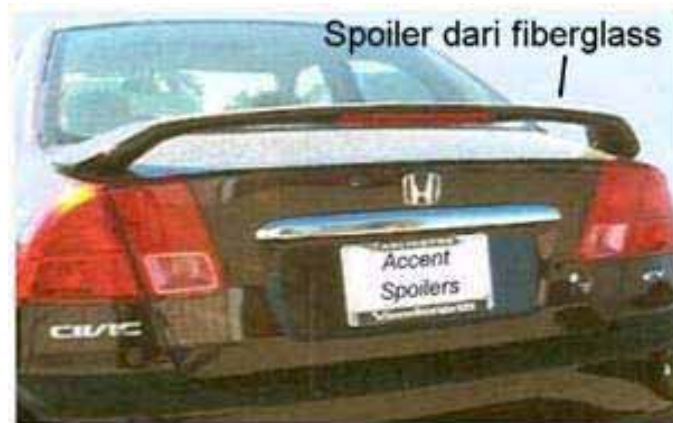
Gambar 12.1. Komponen bodi yang terbuat dari fiberglass
