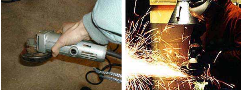
Gambar 11.20. Pekerjaan menggerinda dengan gerinda tangan
