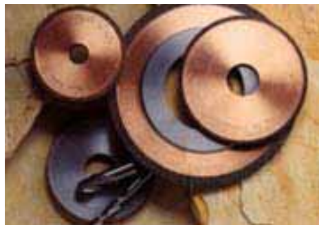
Gambar 11.13. Roda gerinda dari bahan cubic boron nitride
