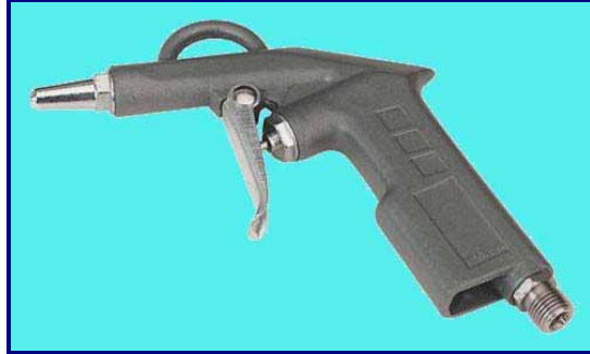
Gambar 17.36. Pistol Udara/ Duster berbahan dari logam
