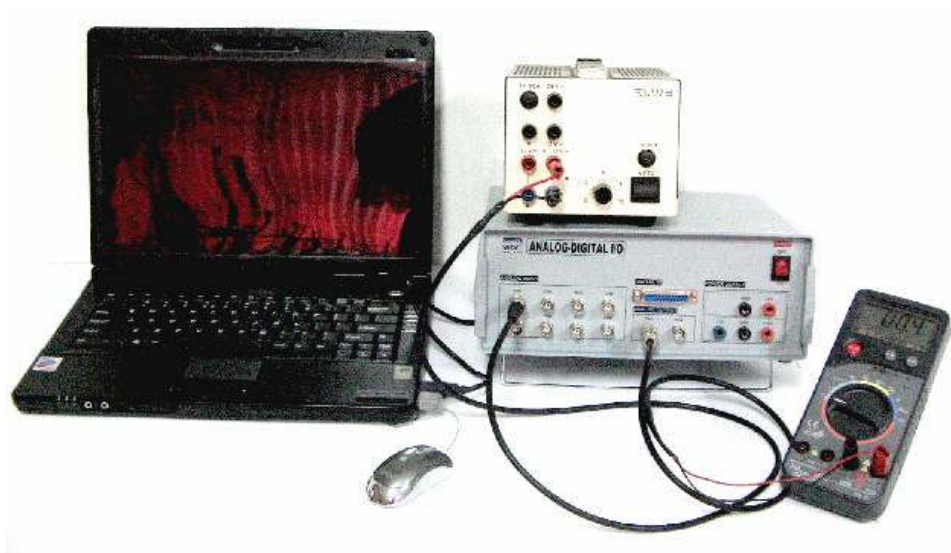
Gambar 9.43 Rangkaian Percobaan Input Output Analog
