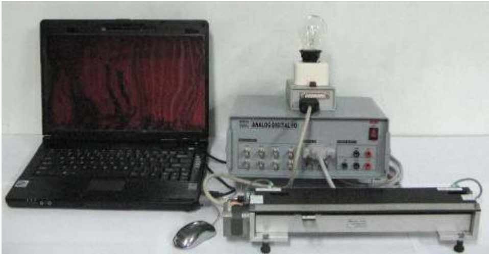
Gambar 9.63 Rangkaian Percobaan Kontrol Posisi Gerak Lurus 1 Axis
