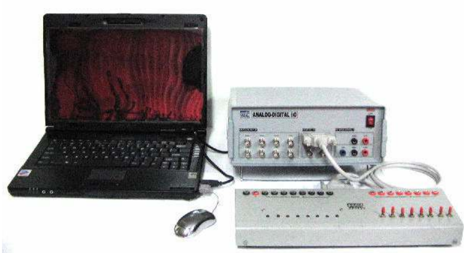
Gambar 9.41 Rangkaian Percobaan Input Output Digital
