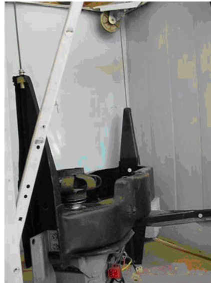
Gambar 3.11 Sistem penyangga pulley
