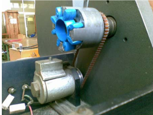
Gambar 5.1 : Pengukuran poros dengan Tachogenerator
