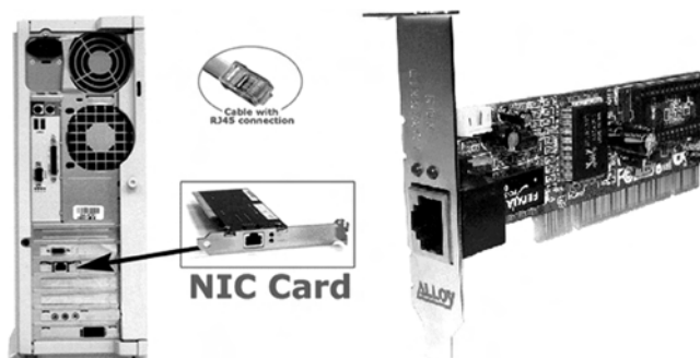
Gambar 1.24. Network Interface Card (NIC) sebagai interface fisik atau penghubung antarkomputer
