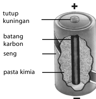
Gambar 8.20 Susunan dasar sebuah elemen kering.
