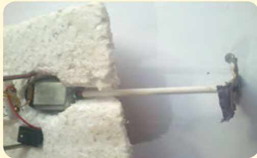
Sumber: Dok. Kemdikbud Gambar 2.48. pemasangan baling-baling ke Motor Listrik DC
