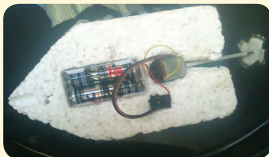
Sumber: Dok. Kemdikbud Gambar 2.50. pemasangan baling-baling ke Motor Listrik DC
