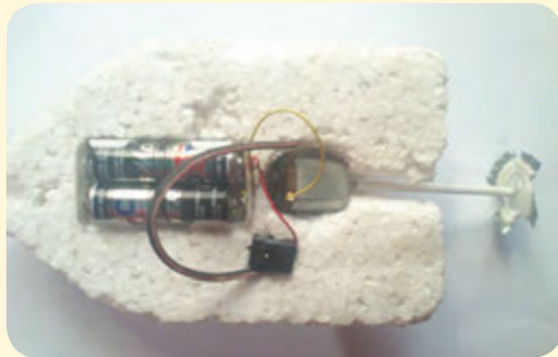
Sumber: Dok. Kemdikbud Gambar 2.49. pemasangan baling-baling ke Motor Listrik DC
