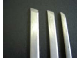
(Sumber: Dokumen Kemdikbud) Gambar 1.16Detail Pahat Pengot
