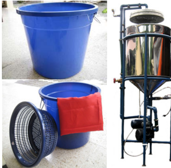
Gambar 2.11 Peralatan yang digunakan dalam proses perendaman, aerasi dan pengendapan
