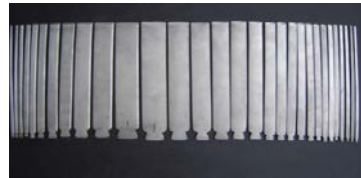
(Sumber: Dokumen Kemdikbud) Gambar 1.13 Pahat Lurus (penyilat) 10 bilah, dan Lengkung (penguku) berjumlah 20 bilah
