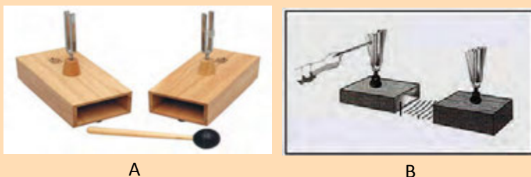
Gambar 9.15. Bagan Garpu tala yang Berfrekuensi Sama (Kanan) dan Percobaan Garpu Tala (Kiri)
