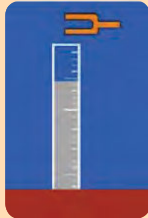
Gambar 9.17 Bagan Percobaan Resonansi
