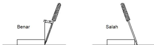
Gambar 4.8. Cara arah menggores benda kerja
