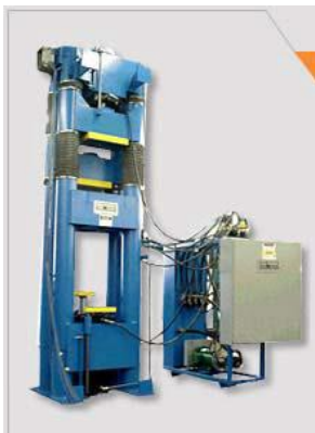
Gambar 9.64. Mesin Squeezing sistem hidrolis
