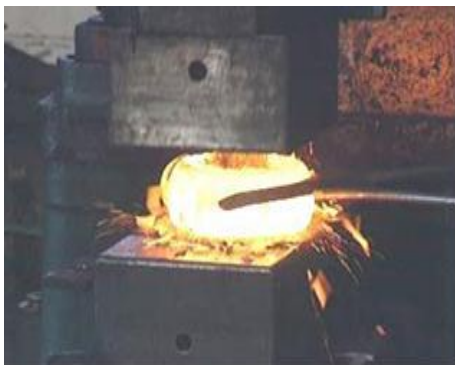
Gambar 9.57. Proses tempa dengan mesin Hammer
