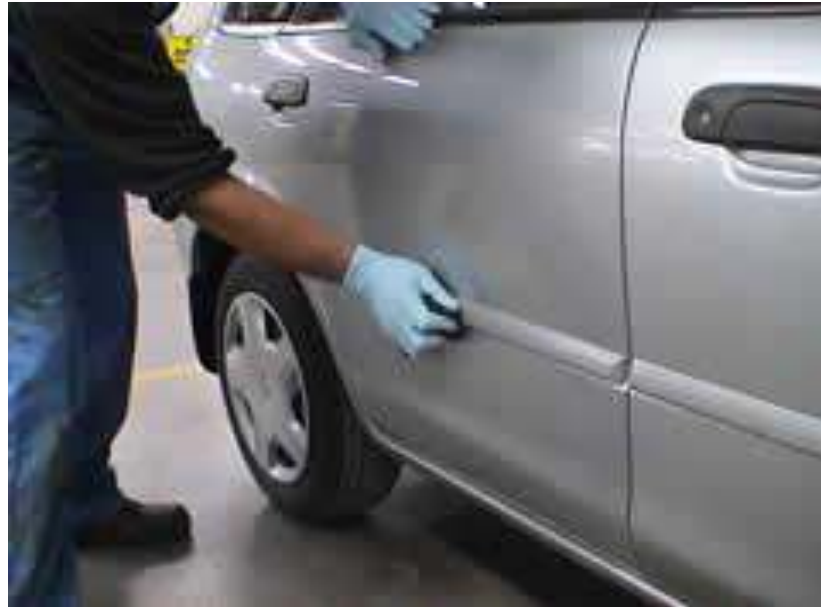
Gb.2.42. Perakatan moulding tersebut dengan cara memberi tekanan dengan menggunakan telapak tangan secara berurutan
