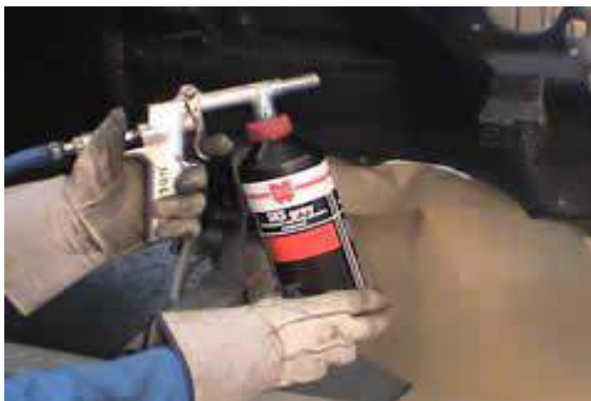
Gb.4.38. Anti-chipping paint diaplikasikan menggunakan sprayer udara
