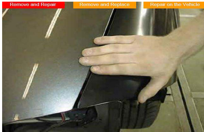
Gb.2.2. Pemeriksaan ketepatan bentuk dan kontur bagian pelindung (guard) yang telah diperbaiki
