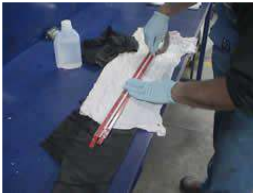
Gb.2.31. Pemasangan pita perekat khusus pada moulding
