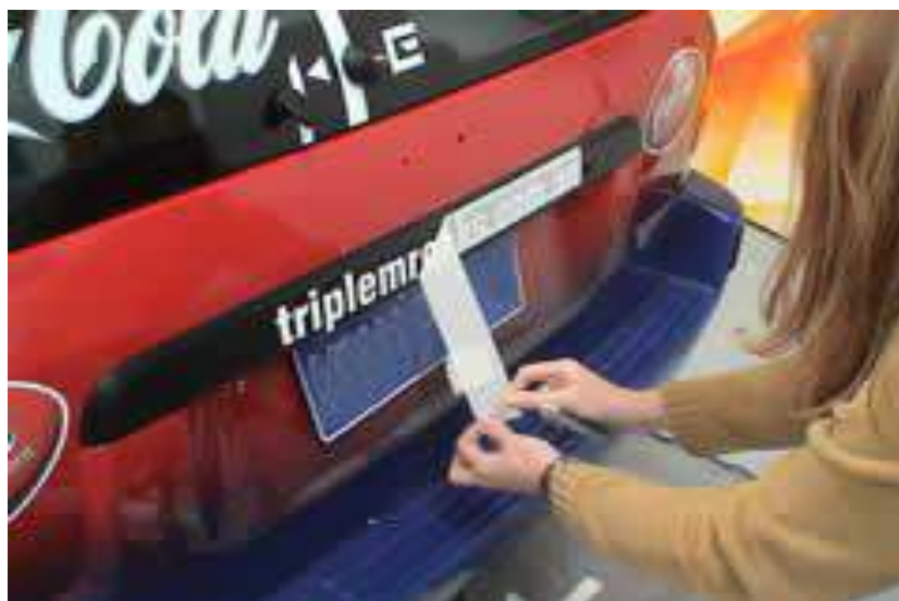
2.57. Pelepasan kertas transfer secara hati-hati
