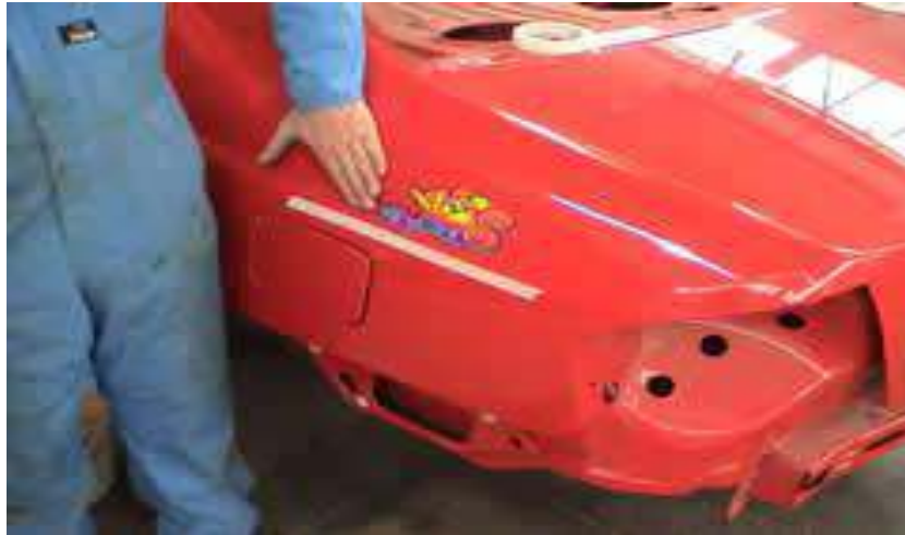
Gb.2.53. Pemeriksaan permukaan decal terhadap kemungkinan terdapat gelembung udara yang terjebak di bawah permukaan decal
