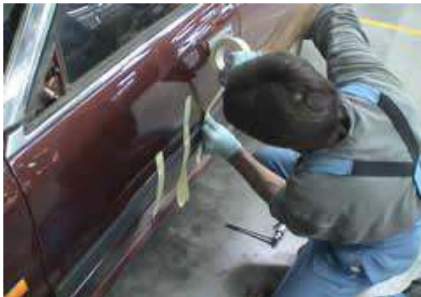
Gb.2.43. Perakatan moulding dapat dibantu dengan menggunakan masking tape
