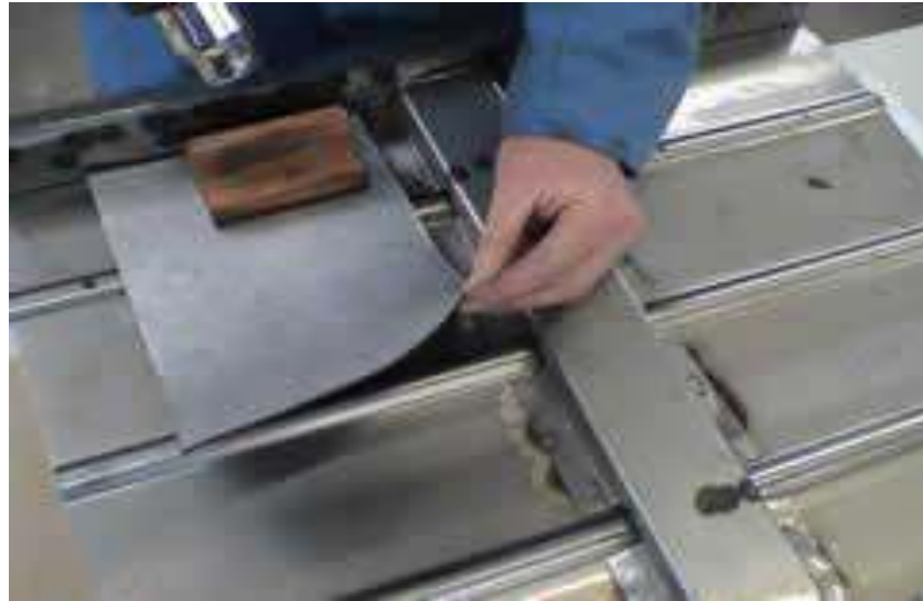
Gb.4.25. Pemasangan lembaran peredam suara
