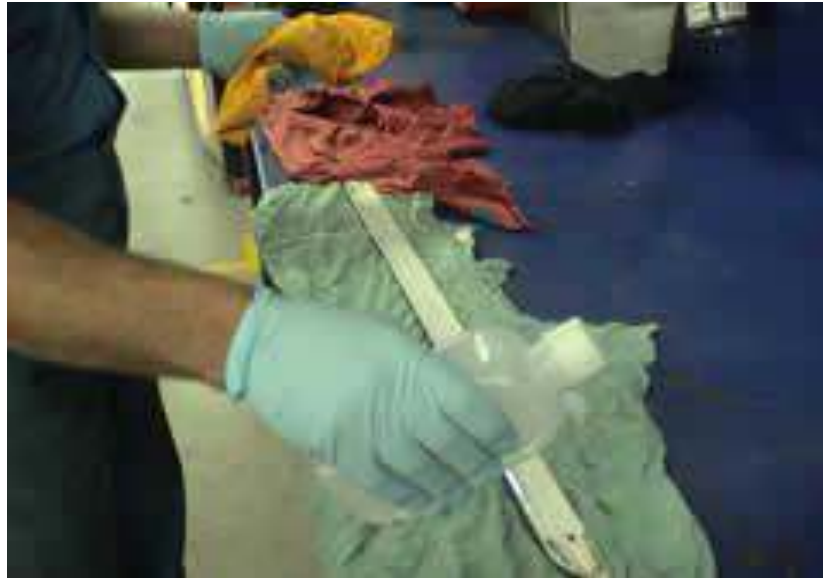
Gb.2.28 Pembersihan akhir moulding dengan menggunakan kain lap yang bersih
