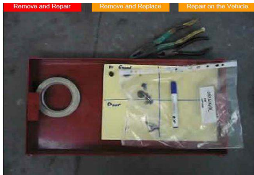
Gb.1.18. Pencatatan dan pengelompokkan masing masing komponen untuk disimpan
