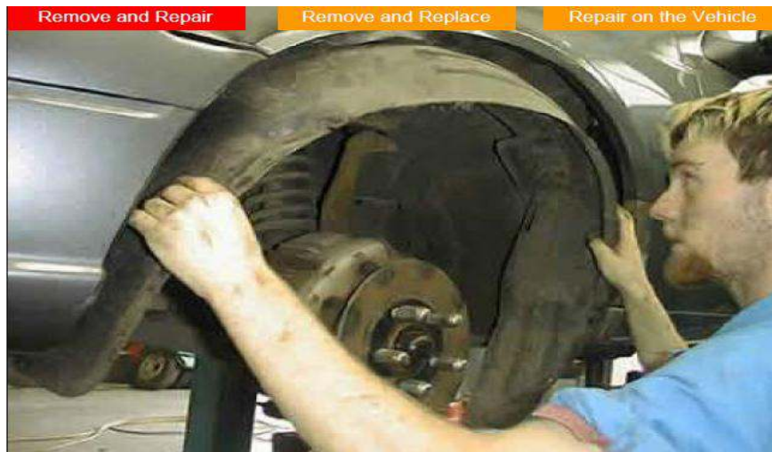
Gb.2.7. Pemasangan penutup kompartemen roda (guard liner)
