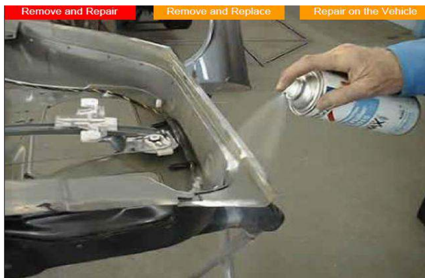
Gb.2.3. Pelapisan primer coating pada seluruh permukaan pelindung (guard)
