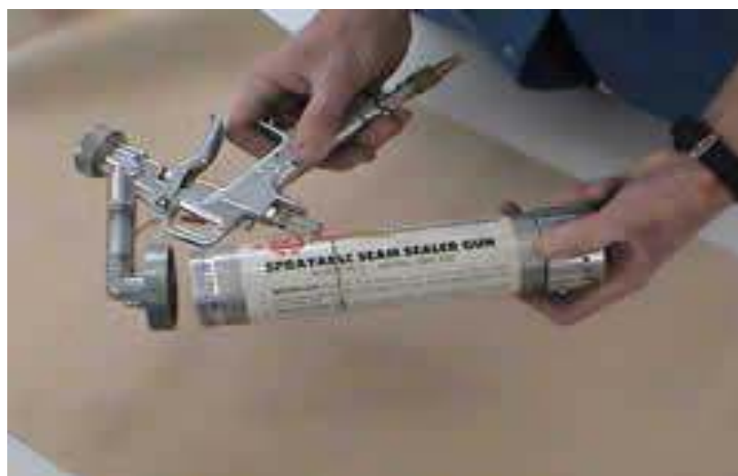
Gb.4.47. Pemasangan kaleng spray-on sealant pada sprayer udara
