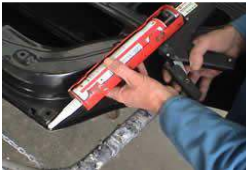
Gb.4.14. Pelapisan sealer sepanjang bidang pengelasan
