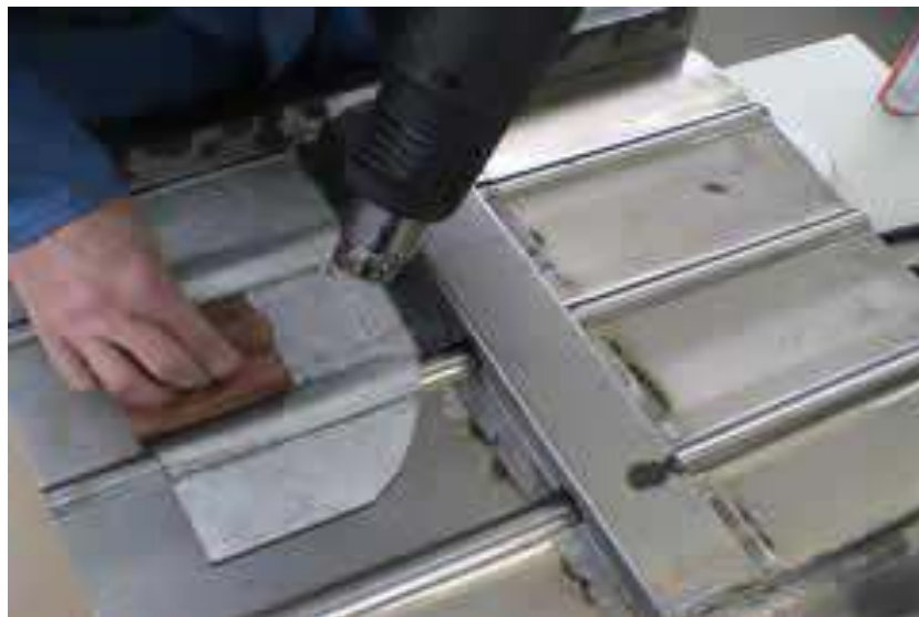
Gb.4.26. Pemanasan permukaan menggunakan heat gun
