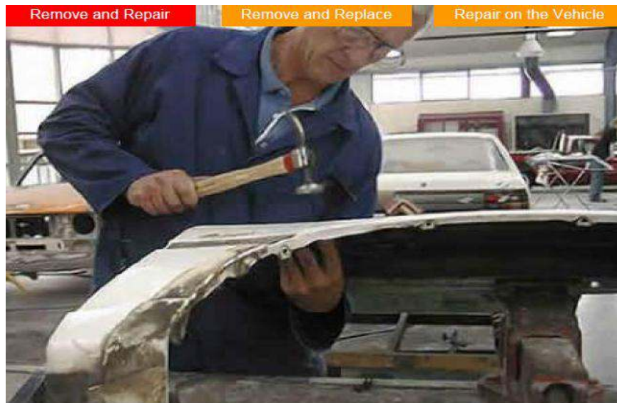
Gb.2.1. Perbaiki pelindung (guard) menggunakan alat-alat perbaikan bodi yang sesuai
