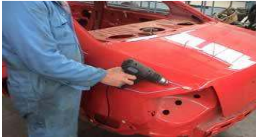
Gb.1.52. Pemanasan pinstrip dengan menggunakan heat gun
