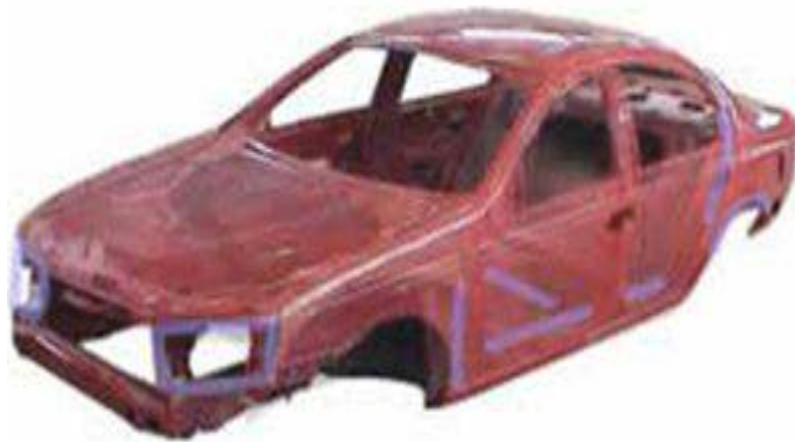
Gb.4.9. Daerah pemasangan join and seam sealer (warna ungu)
