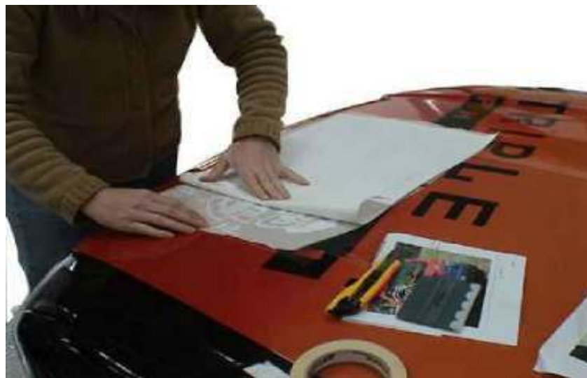
Gb.2.60. Palepasan lembar pelindung bagian paling atas dari decal
