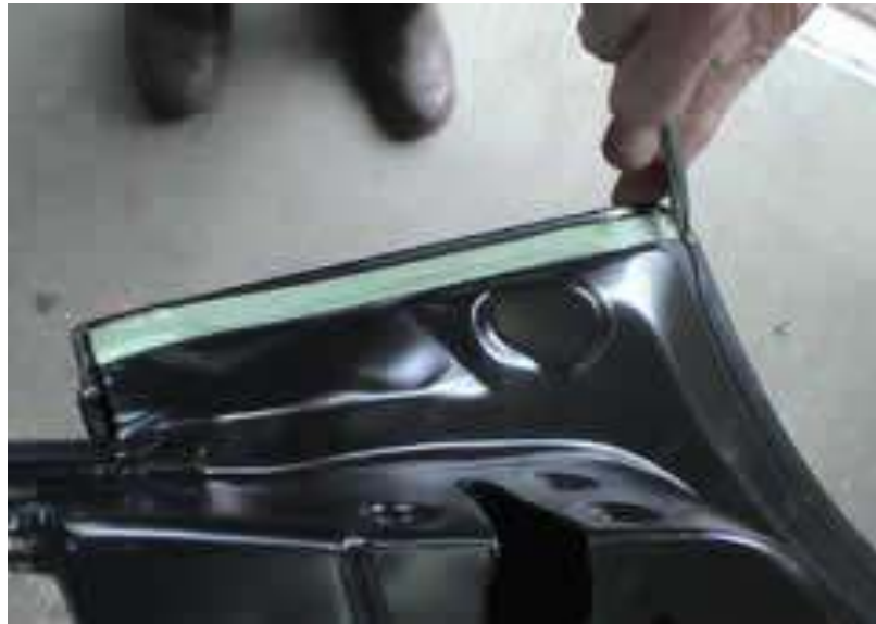
Gb.4.7. Penekanan dengan lembut terhadap seluruh permukaan pita perekat
