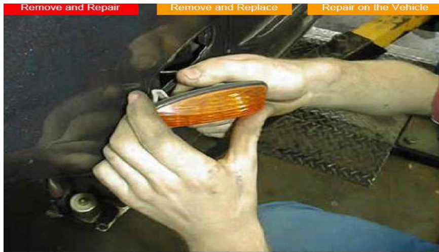
Gb.2.5. Pemasangan lampu-lampu kelistrikan bodi
