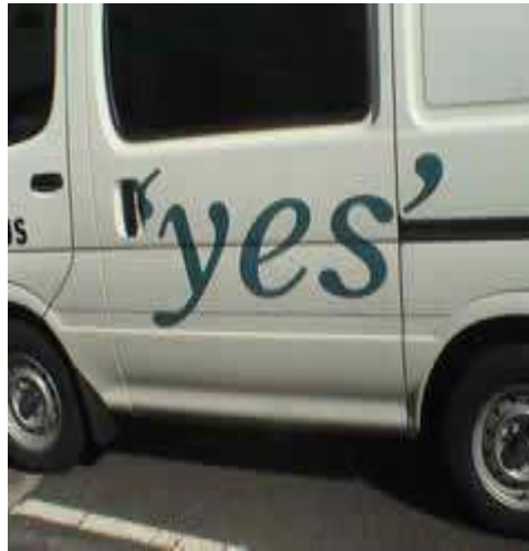
Gb.2.44. Decal dicetak pada lapisan vinyl berperekat
