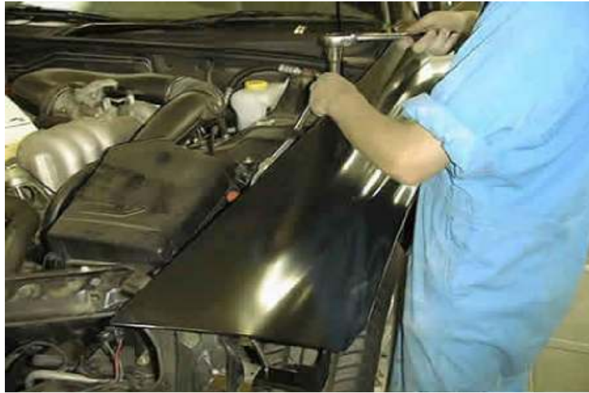
Gb.2.14. Pemasangan kembali pelindung (guard) yang baru
