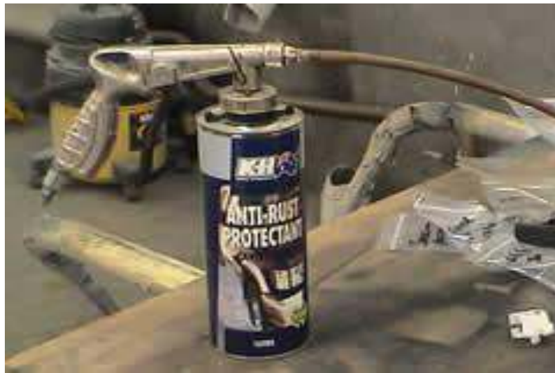
Gb.4.34. Cavity wax diaplikasikan menggunakan sprayer udara
