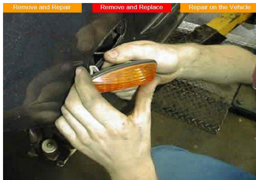
Gb.2.12. Pemasangan kembali komponen kelistrikan
