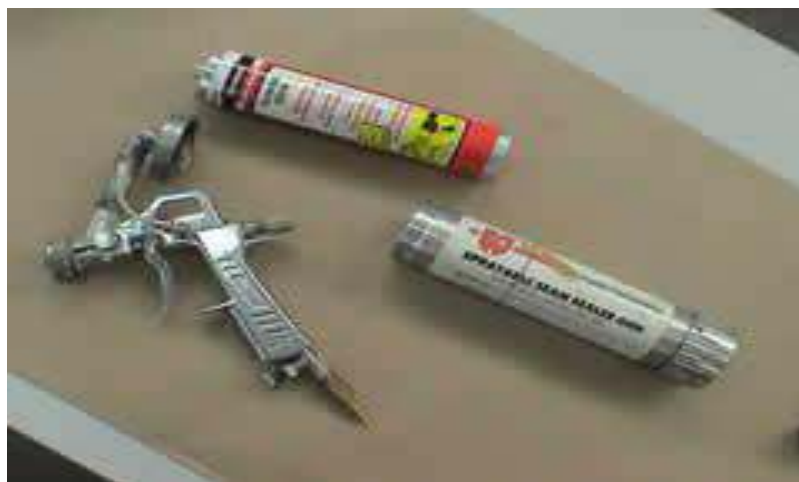
Gb.4.46. spray-on sealant diaplikasikan menggunakan sprayer udara
