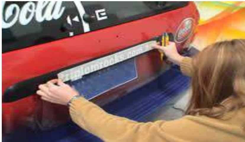
Gb.2.55. Pengaturan posisi pemasangan decal pada permukaan panel bodi kendaraan
