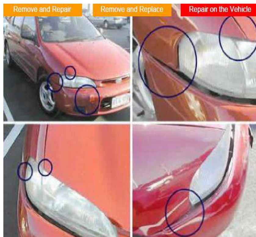
Gb.2.16. Pemeriksaan kerusakan pada pelindung (guard).
