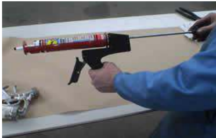
Gb.4.13. Penekanan pelatuk caulking gun ke bagian belakang cartridge
