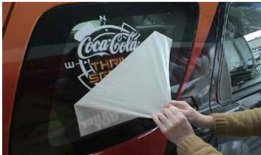
Gb.2.62. Pelepasan kertas transfer dari permukaan decal
