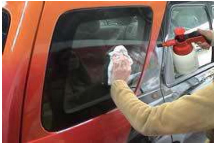
Gb.1.51. Pembersihan sisa lem pada bodi menggunakan cairan pelarut (solvent)
