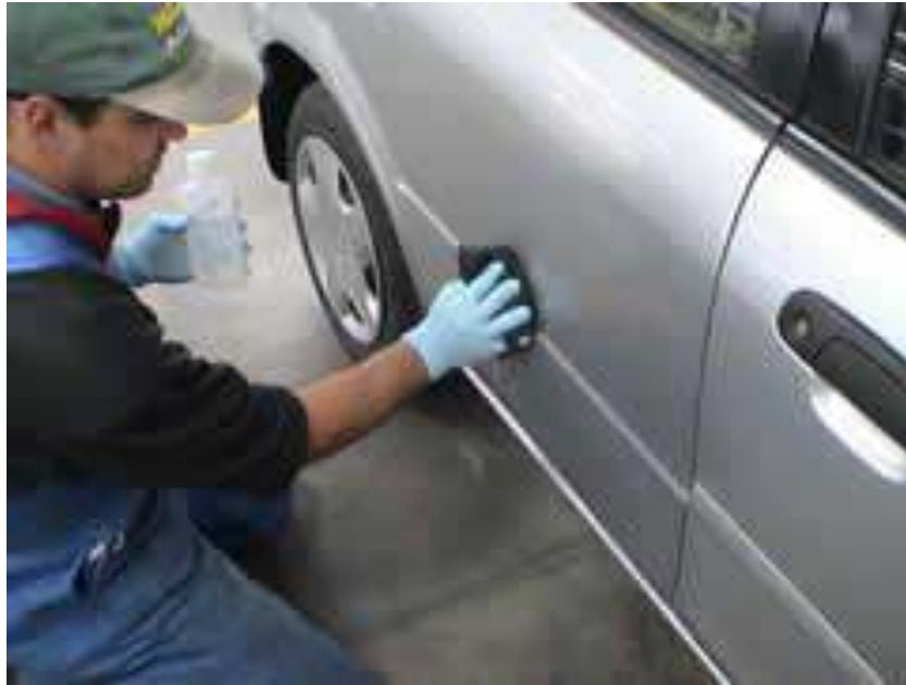
Gb.2.35. Pembersihan panel bodi kendaraan dari jenis kotoran, kerak atau minyak
