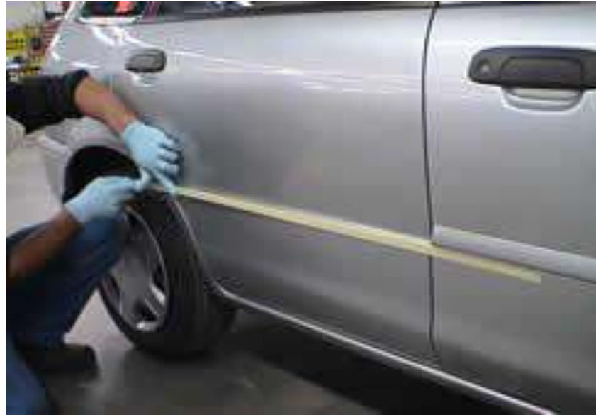
Gb.2.37. Penempatan posisi pemasangan moulding pada bodi kendaraan dengan menggunakan masking tape
