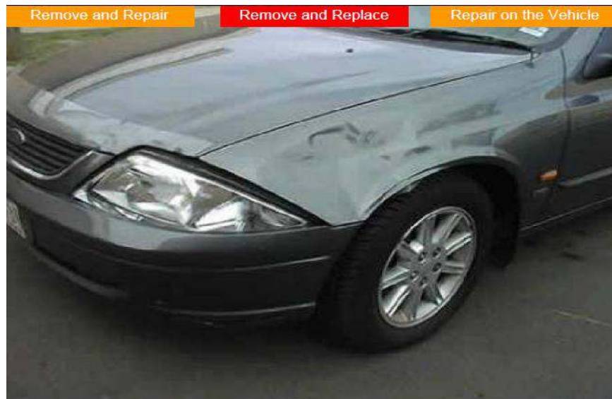
Gb.1.6. Pelindung (guard) yang mengalami kerusakan
