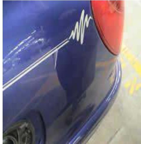
Gb.2.44. Decal dicetak pada lapisan vinyl berperekat
