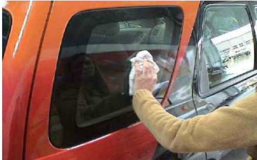
Gb.2.59. Pembersihan permukaan kaca yang akan dipasang dengan decal
