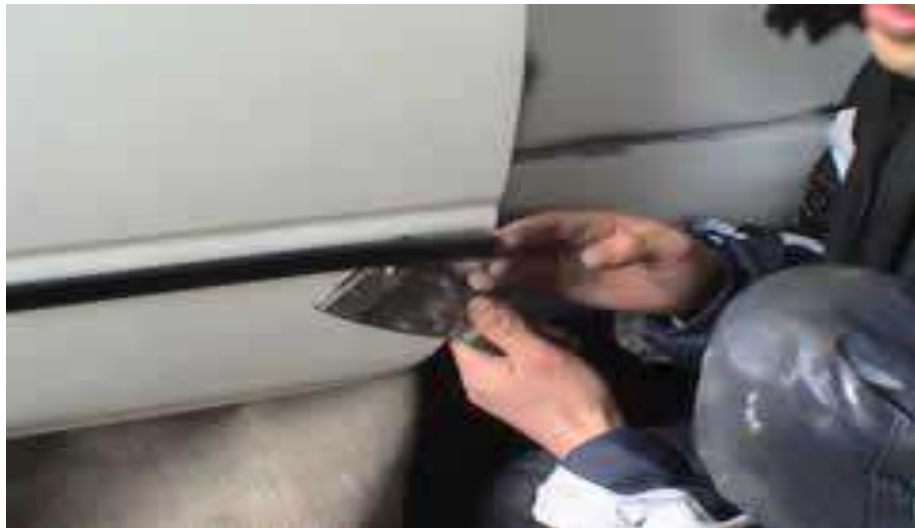
Gb.1.30. Penggunaan kapi/skrap untuk mengungkit moulding
