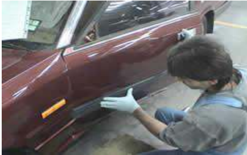
Gb.2.29. Pengukuran panjang dari moulding terhadap dudukannya pada panel kendaraan
