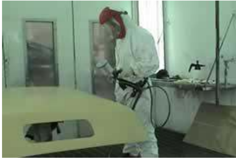
Gb.3.4. Pengecatan pada panel bodi kendaraan
