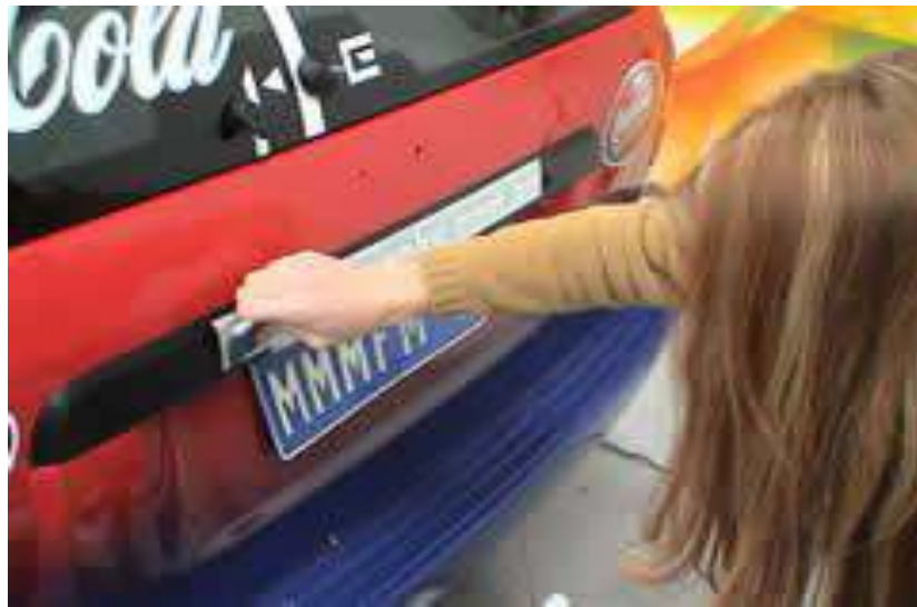
Gb.2.56. Penekanan terhadap permukaan decal dari sisi tengah decal menuju ke sisi ujung decal
