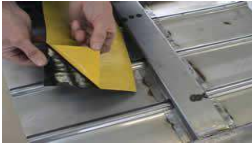
Gb.4.24. Pelepasan kertas pelindung lapisan perekat di bagian belakang lembar peredam suara
