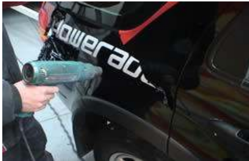
Gb.1.48. Pemanasan permukaan wrap menggunakan heat gun
