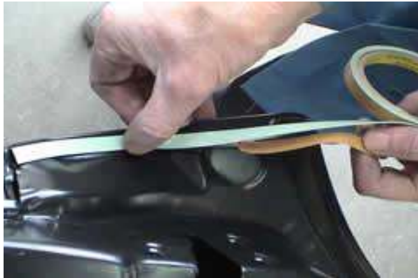
Gb.4.4. Penempelan ujung pita perekat pada bagian sambungan dan tekukan las yang dikehendaki
