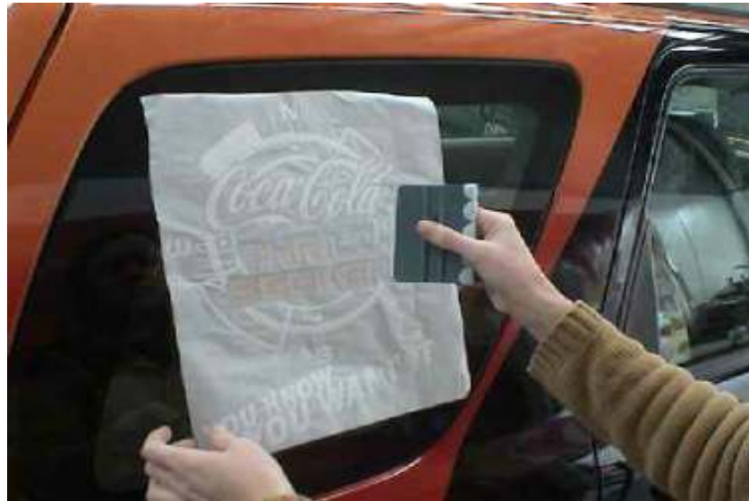
Gb.2.61. Penempelan decal pada permukaan kaca kendaraan
