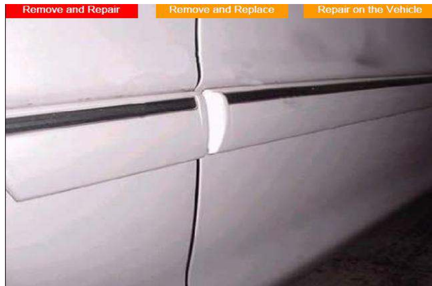
Gb.2.6. Pemasangan moulding,badges dan pin pada pelindung (guard)
