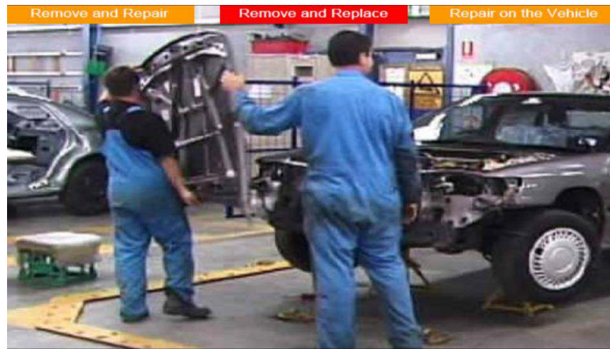
Gb.1.12. Pelepasan bonnet (kap mesin)
