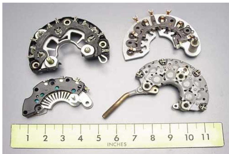
Gambar 2.20 Dide alternator dengat het sink
