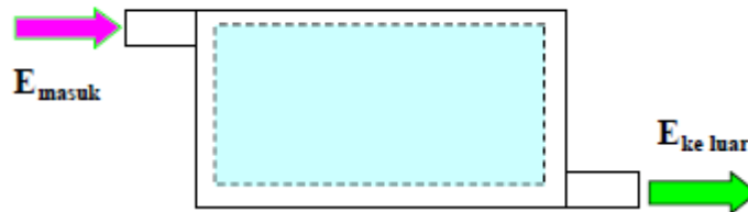
Gambar 2.11 Proses perubahan energi pada sistem terbuka
