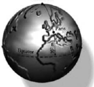
Gambar 1.2. Satu meter pernah ditetapkan sebagai jarak antara equator (katulistiwa) dan kutub utara melalui Paris ( Sumber: Tipler, Physics for Scientists and Engineers , 5 th edition)
