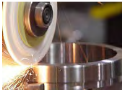
Gambar 1.5. Prinsip kerja mesin gerinda datar spindel horizontal dengan gerak meja berputar
