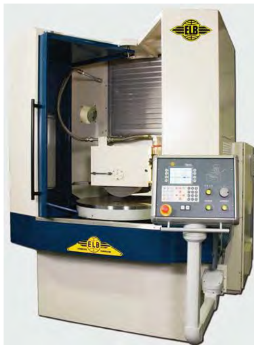
Gambar 1 6. Mesin Gerinda datar horizontal gerak meja berputar.
