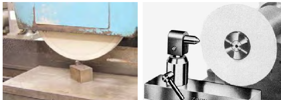
Gambar 2.37. Hasil pembentukan roda gerinda bentuk rata dengan pemegang dresser bentuk standar
