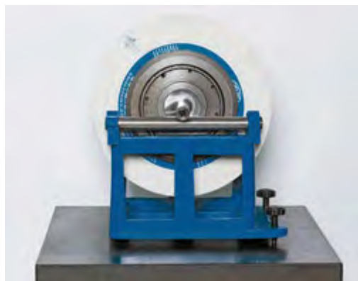
Gambar 2.64. Posisi roda gerinda setimbang
