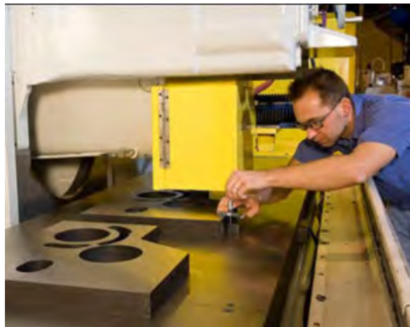
Gambar 4.22. Proses pengukuran hasil penggerindaan yang benar dan aman
