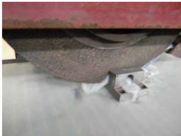
Gambar 4.18. Penggerindaan alur/profil dengan meja magnet
