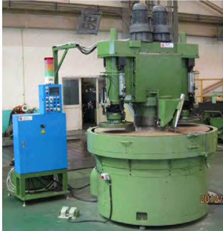
Gambar 1.12. Mesin gerinda datar posisi spindel vertical dengan gerak meja berputar (spindel mesin dua buah)
