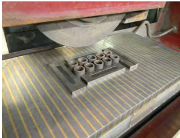
Gambar 4.5. Pengikatan benda kerja yang memiliki ukuran relatif kecil
