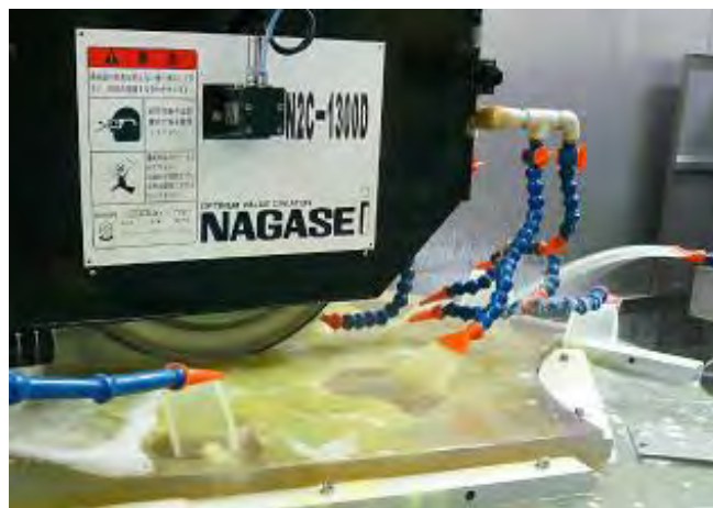
Gambar 4.15. Posisi nozzle harus dapat diatur dengan mudah
