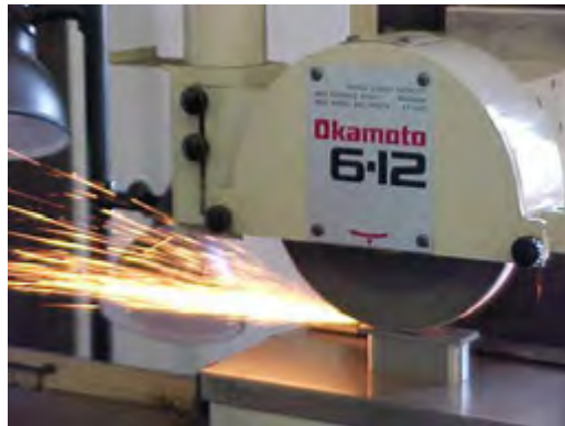
Gambar 1.2. Prinsip kerja mesin gerinda datar spindel horizontal dengan gerak meja bolak-balik
