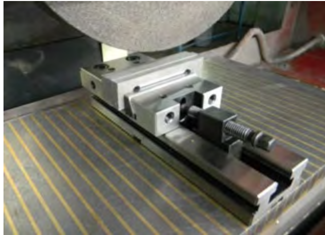
Gambar 4.8. Pengikatan benda kerja yang memiliki ukuran relatif pendek
