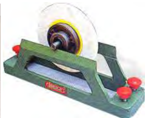
Gambar 1.45. Dudukan penyetimbang dengan batang pipih dan contoh penggunaannya
