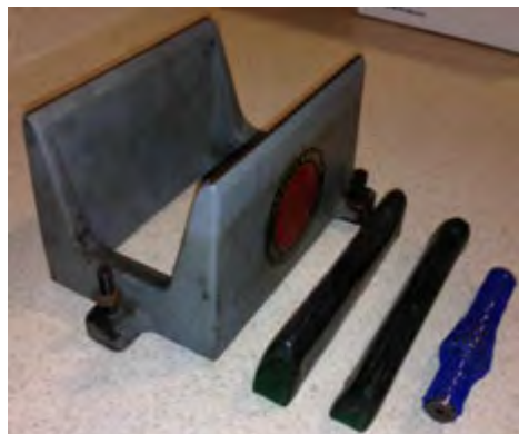
Gambar 1.45. Dudukan penyetimbang dengan batang pipih dan contoh penggunaannya
