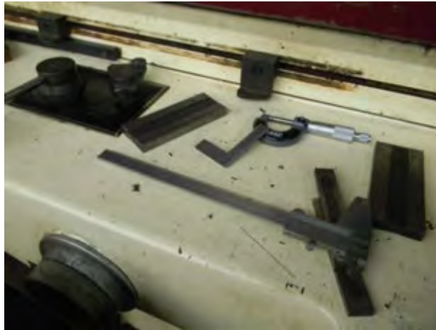
Gambar 4.23. Penempatan peralatan kerja yang tidak aman
