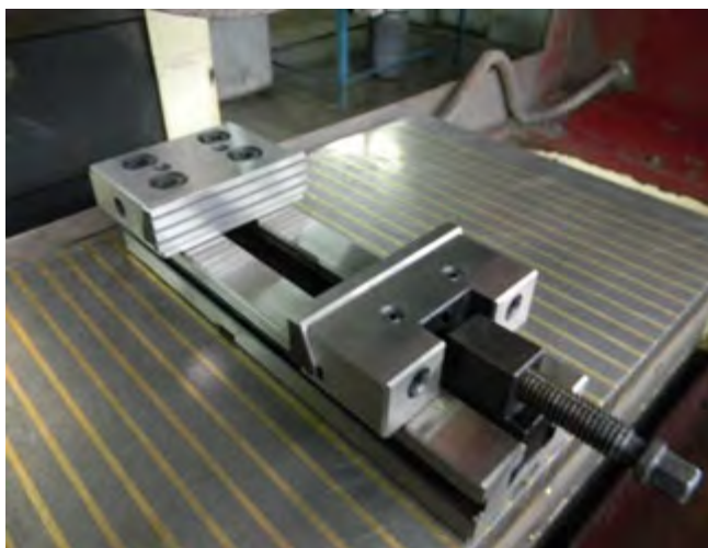
Gambar 4.7. Kondisi ragum presisi harus bersih
