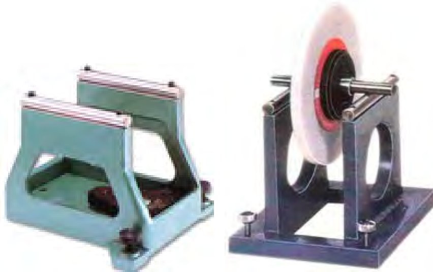
Gambar 1.46. Dudukan penyetimbang dengan batang lurus dan contoh penggunaannya
