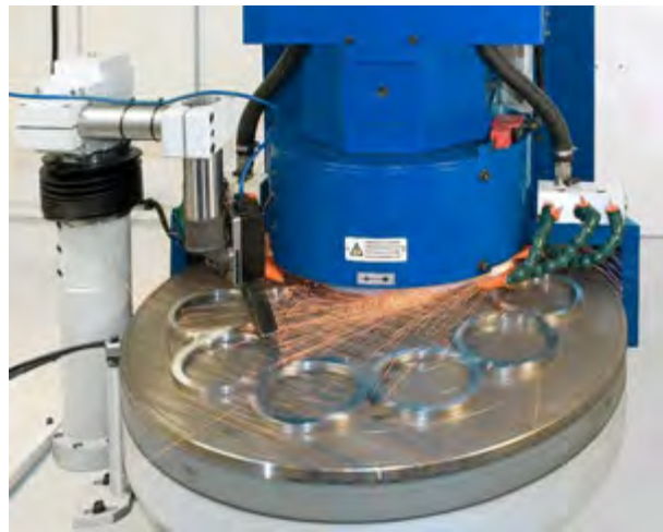
Gambar 1.9. Prinsip kerja mesin gerinda datar spindel vertical dengan gerak meja berputar
