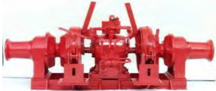
Gambar 129. Winch/gardan di kapal pukat hela
