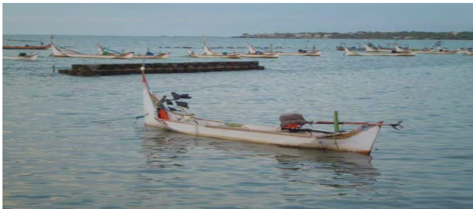
Gambar 118. Perahu dengan mesin compreg yang digunakan untuk memasang bubu/jaring rajungan. Dioperasikan oleh 1-2 orang
