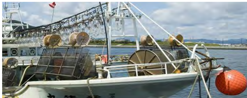
Gambar 165. Kapal pancing cumi dengan rak yang dilipat ketika tidak digunakan
