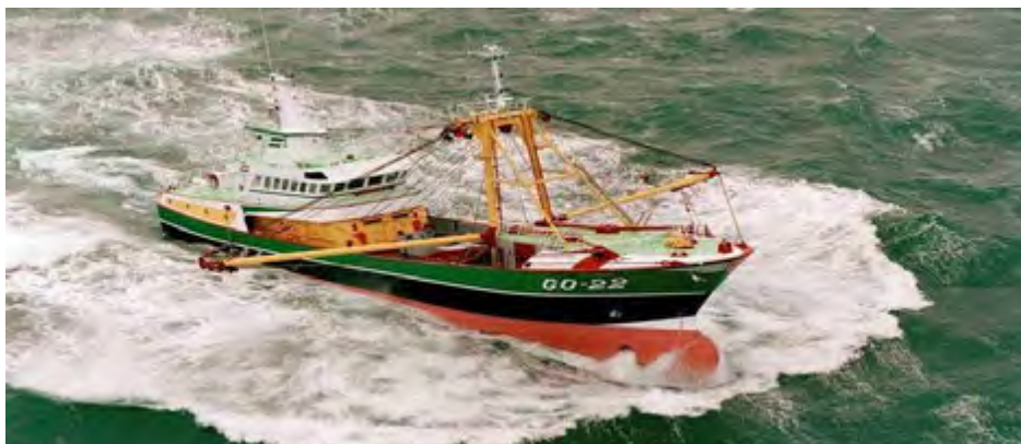
Gambar 140. Beam trawl, 484 GT, Panjang 41 m, dalam 5 m dengan boom 9 m yang dibuka di sisi kapal
