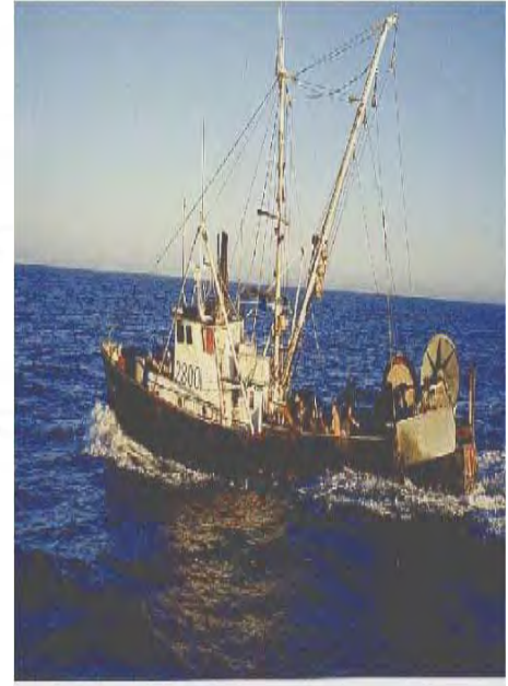
Gambar 151. Konstruksi kapal bottom trawl 126 GT, panjang 22 m 1
