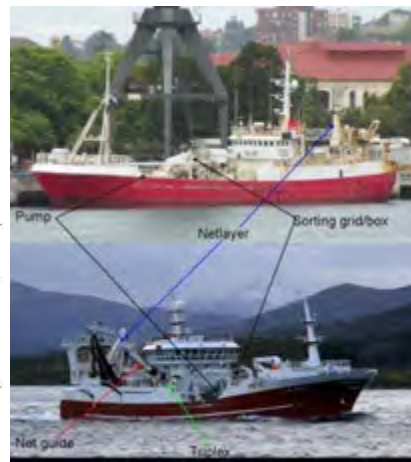
Gambar 132. Kapal purse seine, panjang 26 m, lebar 7 m
