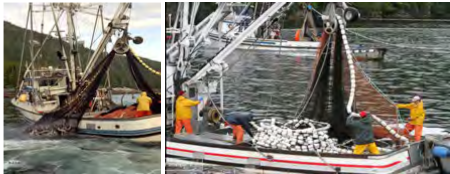
Gambar 130. Hauling kapal pukat cincin 1 kapal menggunakan alat bantu mekanis
