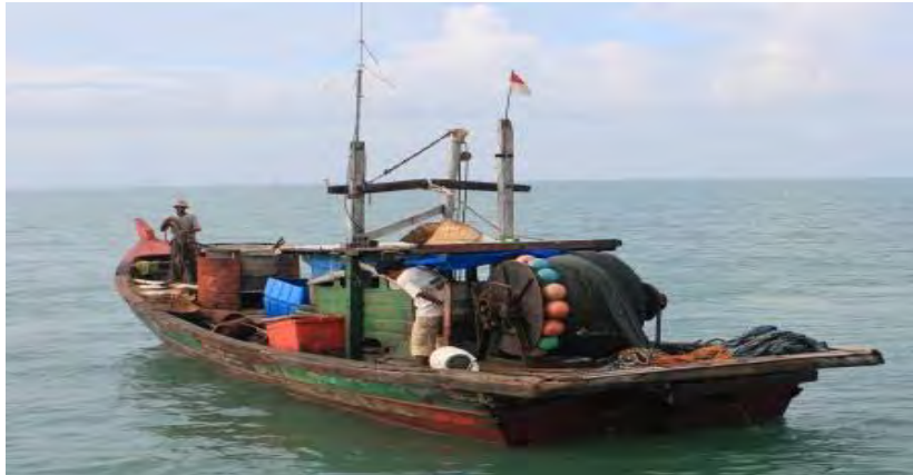
Gambar 112. Kapal gillnet dengan drum net
