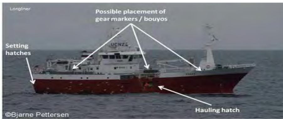
Gambar 173. Lokasi setting dan hauling pada kapal longline
