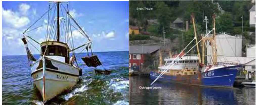
Gambar 146. Kapal trawl udang dengan dua outrigger
