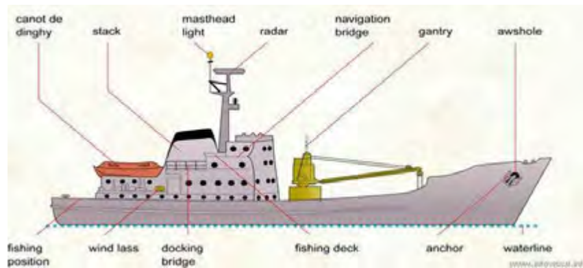
Gambar 138. Bagian-bagian kapal trawl
