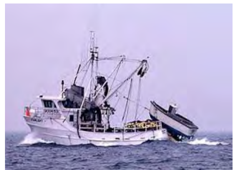
Gambar 130. Hauling kapal pukat cincin 1 kapal menggunakan alat bantu mekanis
