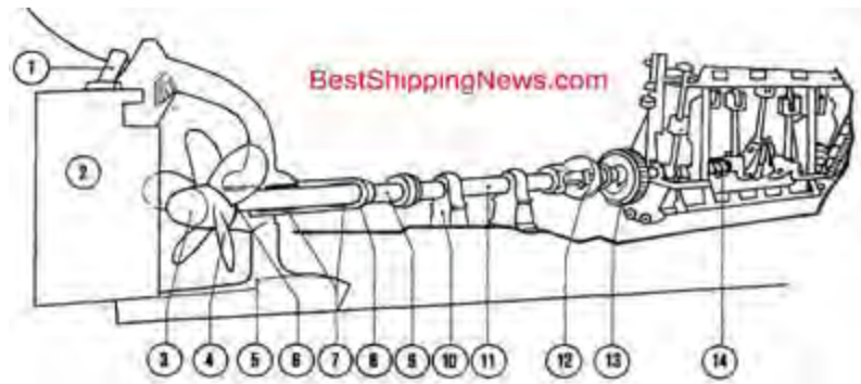
Gambar 55. Instalasi penggerak kapal
