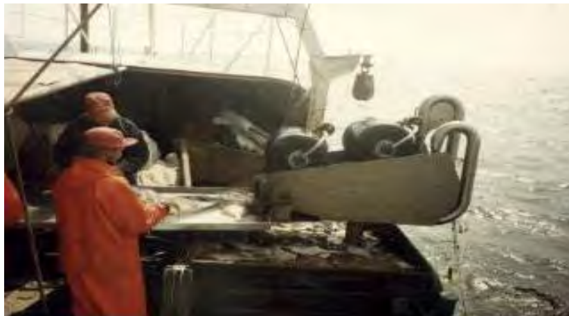
Gambar 115. Hauling gillnet menggunakan net hauler
