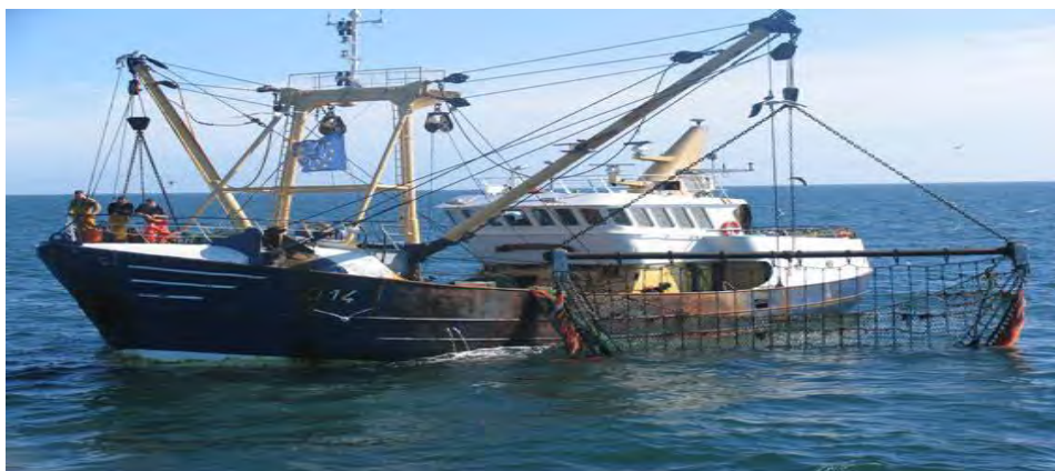
Gambar 141. Kapal beam trawl sedang menaikkan alat tangkap
