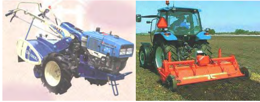
Gambar 24. Bajak Rotary Traktor Roda dua (kiri) Roda Empat (kanan)
