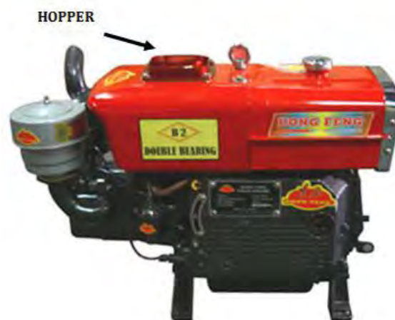
Gambar 112. Motor Diesel dengan pendingin sistem hopper
