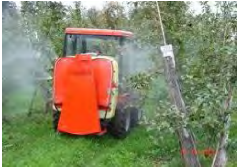
Gambar 54. Alat penghembus dengan tenaga PTO traktor
