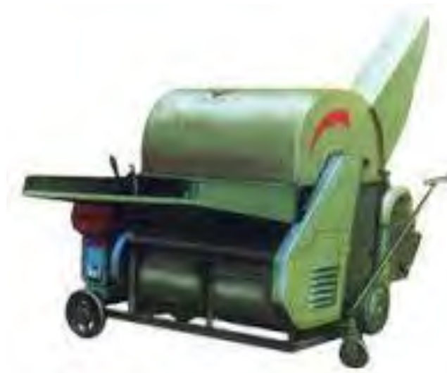
Gambar 66. Paddy Thresher dengan tenaga mesin
