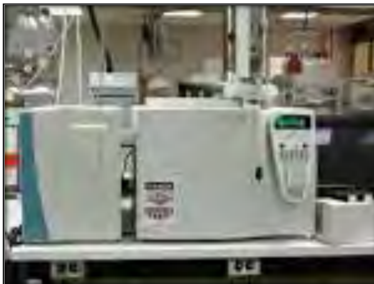
Gambar 12. Contoh analisis instrumen dengan dengan HPLC,
