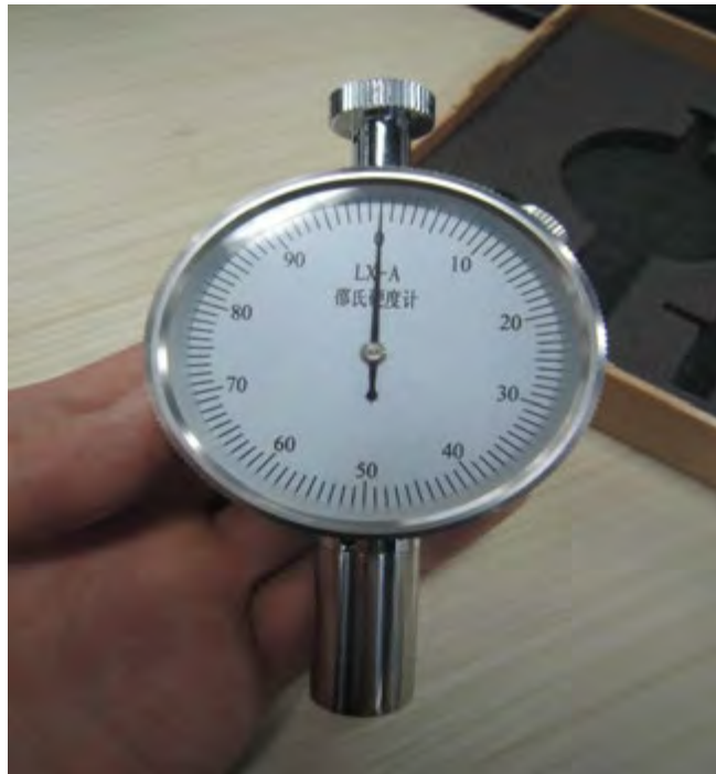
Portable Double Pointer Shore kekerasan Tester / Durometer LX-A-2 Untuk mengukur kekerasan karet, kulit, lilin dan lain-lain.
