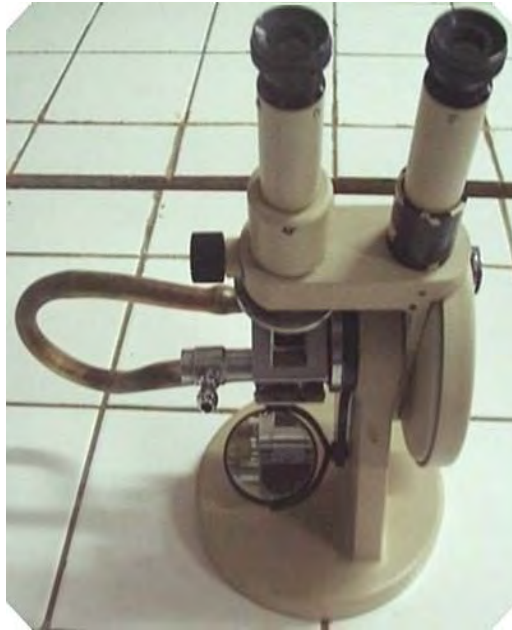
Gambar 21. Alat Penetapan Index Bias (Refraktometer)
