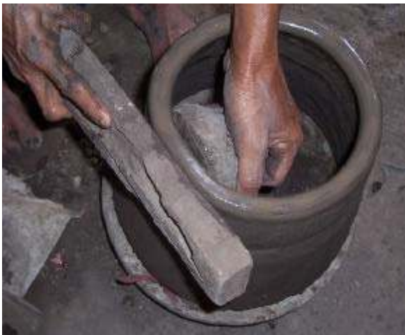
Gambar 5.33. Membuat keramik dengan teknik putar tatap ( paddle and anvil technique )(sumber: Koleksi studio keramik)
