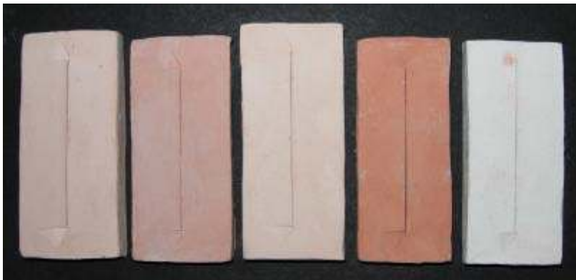
Gambar 6.16. Perbedaan warna tanah liat setelah dibakar biskuit suhu 900°C (sumber: Koleksi studio keramik)
