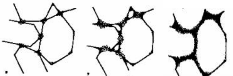
Gambar 6.12. Efek vitrifikasi . (sumber: Frank Hammer)
