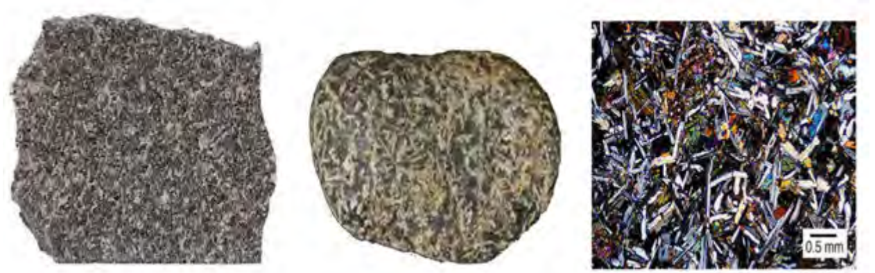
Gambar : Batuan beku plutonik , Jenis batuan beku basa, nama : batu Diabas
