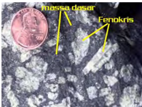
Batuan dengan Tekstur Inequigranular Porfiritik
