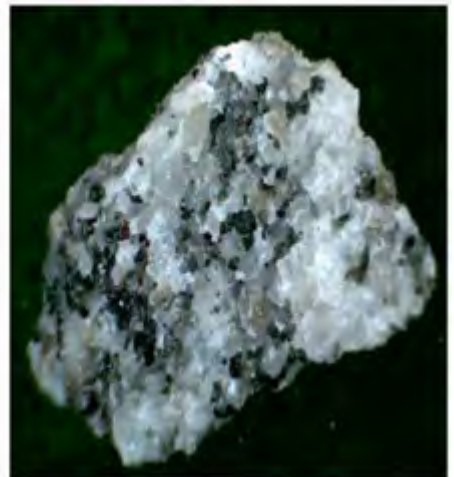
Gambar : Batuan beku plutonik , Jenis batuan beku asam, nama : batu Tonalite
