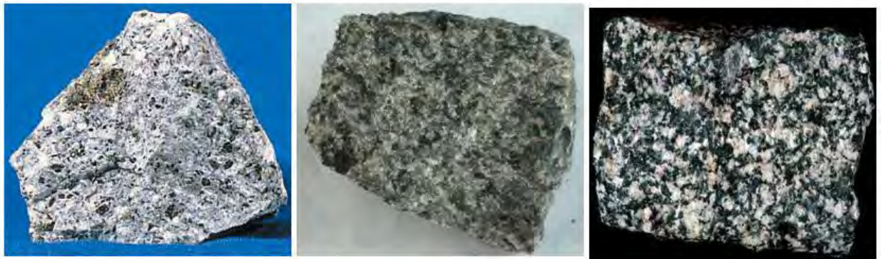
Gambar : Batuan beku plutonik , Jenis batuan beku intermediate, nama : batu Syenite
