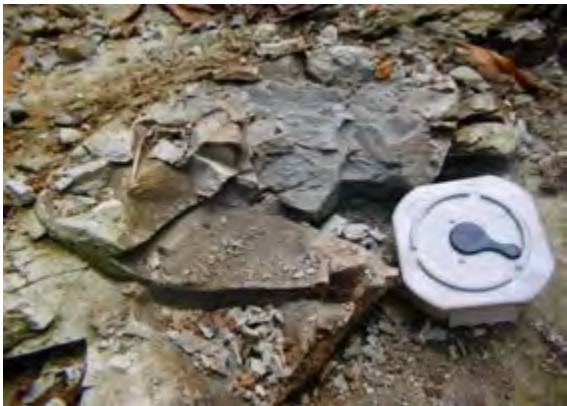
Gambar 1.57. Batuan sedimen Klastik Golongan Detritus halus , batulempung, perhatikan tidak tampak bidang perlapisannya dan perhatikan pula pecahannya yang membulat (konkoidal) sebagai ciri khas batulempung.
