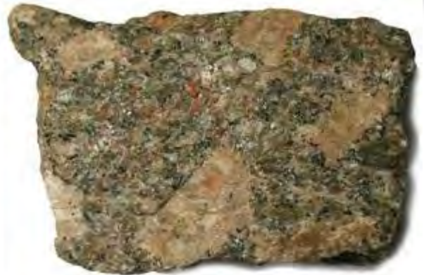
Gambar : Batuan beku plutonik , batu Jenis batuan beku asam, nama batu : Monzoquartz (kiri) dan Monzogranit (kanan).
