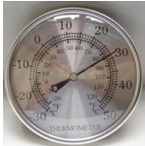
Sumber: www.diytrade.com Gambar 4.7 Termometer bimetal, digunakan untuk pengukuran suhu
