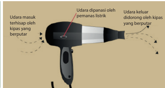
Sumber: Dok. Kemdikbud Gambar 4.22 Konveksi pada pengering rambut
