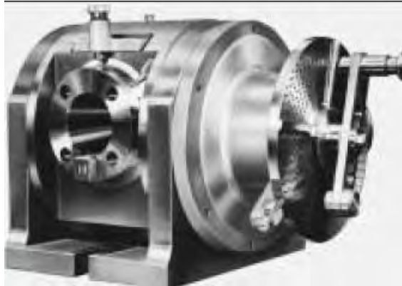
Gambar 3. 20. Kepala pembagi ( dividing head ) untuk membuat segi banyak dan roda gigi
