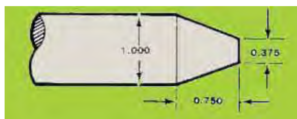
Gambar 2.26. Ujung benda kerja di- champer untuk memperkecil tekanan pahat kartel
