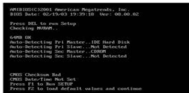
Gambar 57 Tampilan BIOS saat NVRAM mengalami kerusakan atau saat baterai litium CR-2032 habis dayanya atau dicabut dari slotnya
