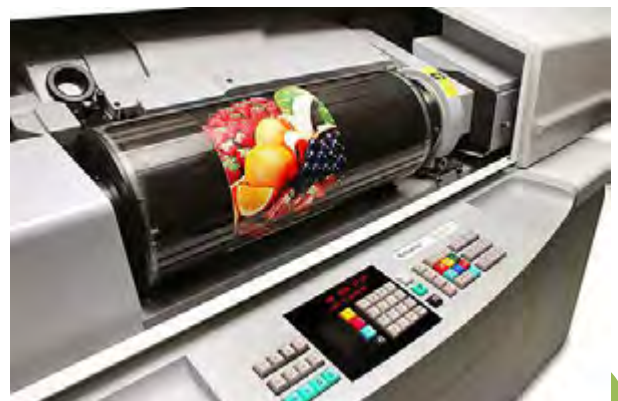
Gambar 4.7 Drum scanner termasuk kelas high end karena kualitas sebanding dengan harganya yang mahal
