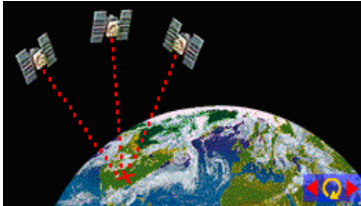
Gambar 29. Bagaimana Satelit GPS Mengirim Sinyal
