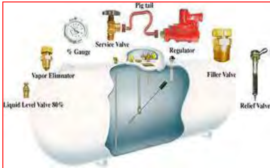
Gambar 21. Peralatan kontrol dan safety pada tangki bahan bakar cair. ( www.bharattanksandvessel.com ).
