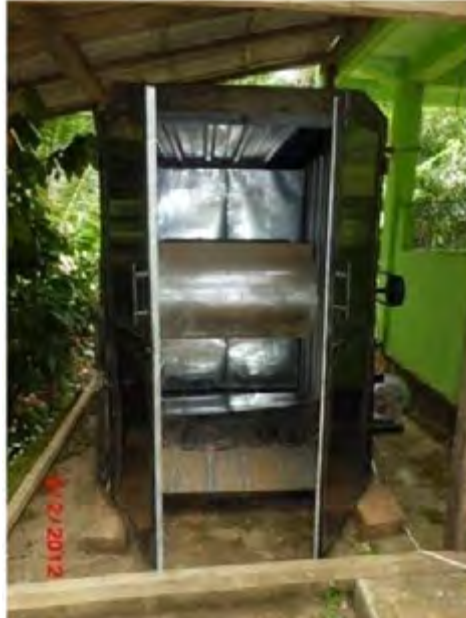
Gambar 12. Mesin Pengering Tanaman menggunakan Listrik PLTMH
