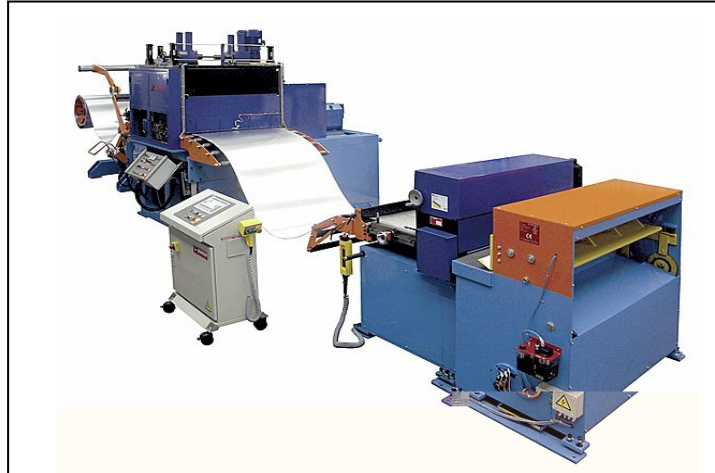
Gambar 1.3. Mesin Blanking dengan sistem Program NC
