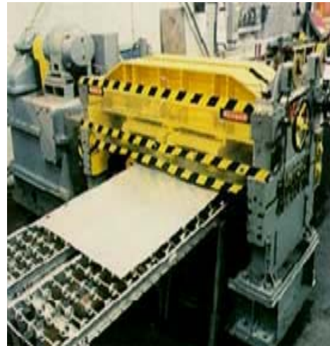
Gambar 3.10. Proses mengerolan pelat baja tipis
