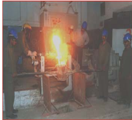
Gambar 3.12 Pembuatan baja paduan
