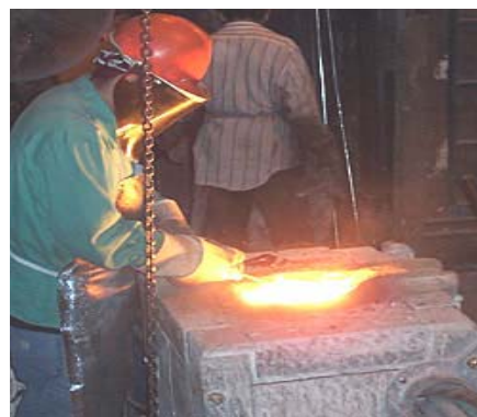
Gambar 3.15. Proses pencampuran unsur lain pada pembuatan baja noduan
