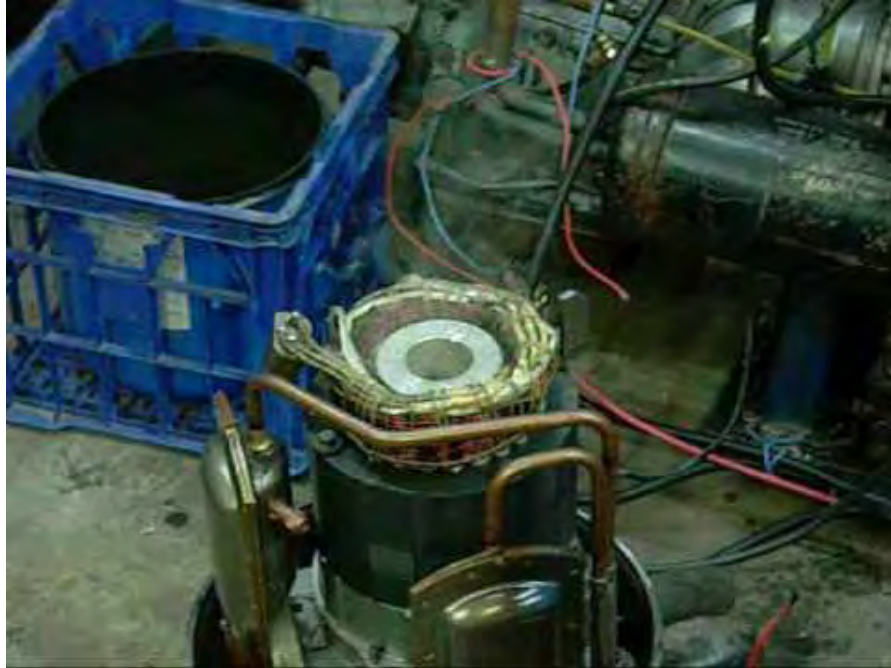
Gambar 4. 2 Belitan Motor Kompresor Hermetik Terbakar
