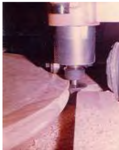
Memprofil Sisi tebal Kayu memakai mesin over head Router
