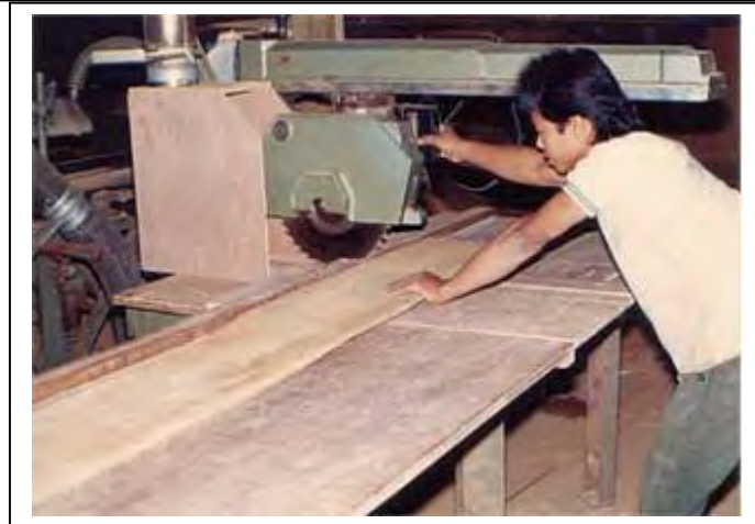
Memotong papan menggunakan mesin Radial arm saw
