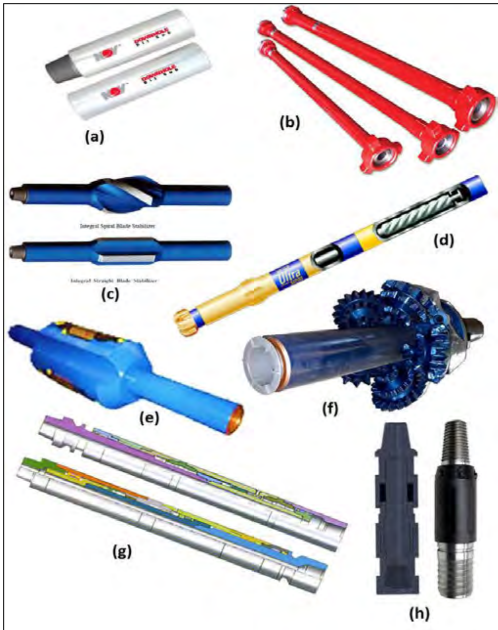
Gambar 4.29. Bottom Hole Assembly : (a) Bit Sub ; (b) Pup Joint ; (c) Stabilizer ; (d) Down Hole Motor ; (e) Under Reamer ; (f) Hole Opener ; (g) Drilling Jar ; (h) Shock Absorber
