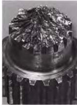
Gambar 11.4 – Kerusakan torque (torsi) yang berbentuk bintang
