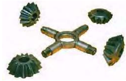
Gambar 9.14 Foto potongan dari rangkaian differential secara lengkap
