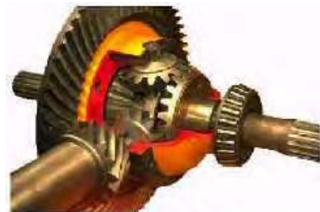
Gambar 9.15 Menunjukkan spider dan gear
