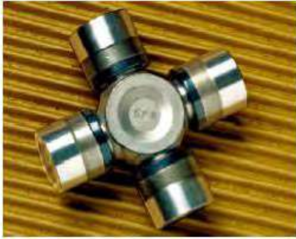
Gambar 7.28 – Model bentuk jaring yang dilumasi secara permanen
