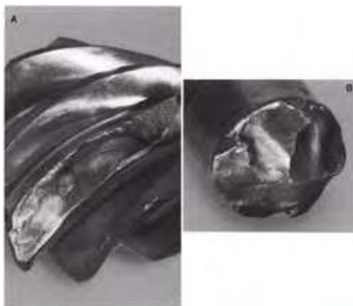
Gambar 11.5 – Kerusakan torque (torsi) yang puntiran
