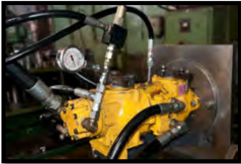
Gambar 3.13 Menguji pompa hidrolis
