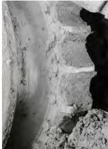
Gambar 6.5 Packing pada sprocket
