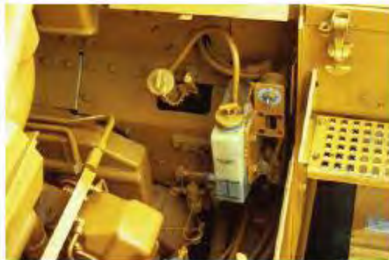
Gambar 6.13 – Ketinggian permukaan oli untuk Pivot Shaft Compartment
