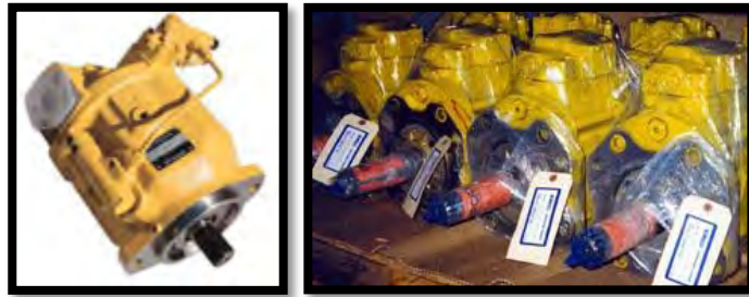
Gambar 3.5 Pompa baru (kiri) dan remanufaktur (kanan)
