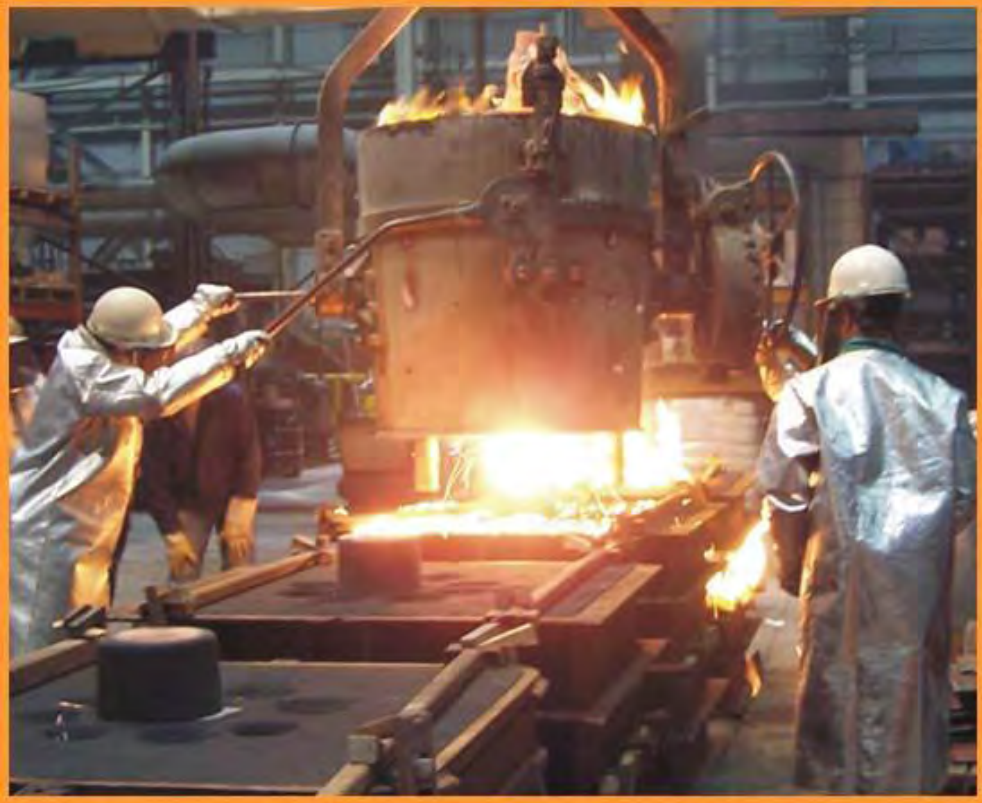
Ladel Bottom Up Pouring
