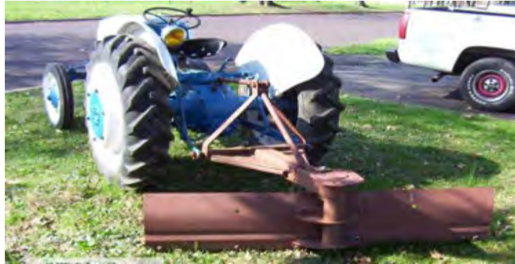
Gambar 5: Traktor yang dilengkapi dengan tiga-titik gandeng ( three point linkage/hitch ) dan kontrol hidrolik
