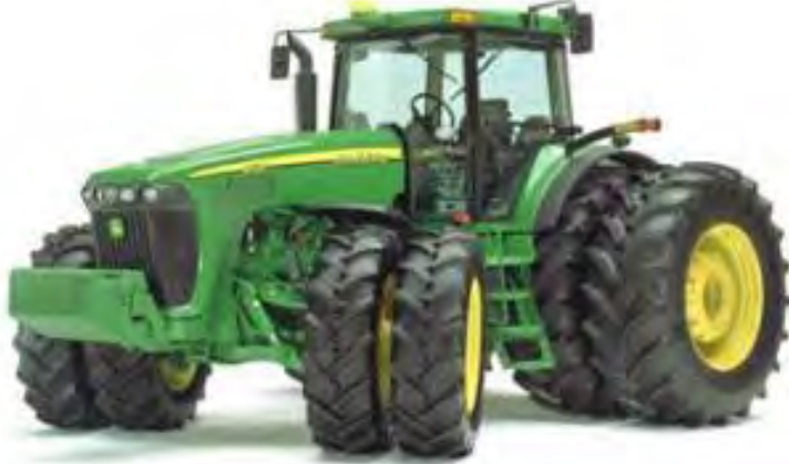
Gambar 6: Traktor dengan empat roda penggerak ( 4 wheel drive ), sehingga perlu power steering untuk menggerakkan roda depan
