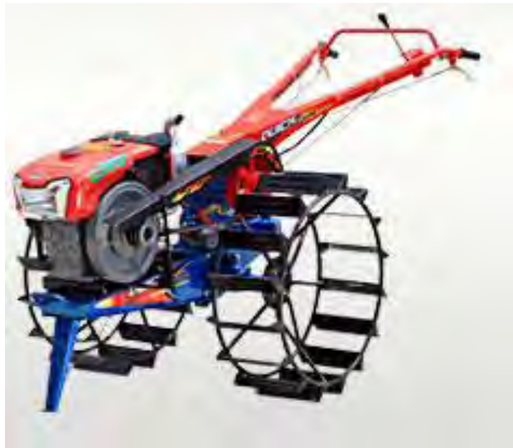
Gambar 7: traktor tangan dengan konstruksi sederhana
