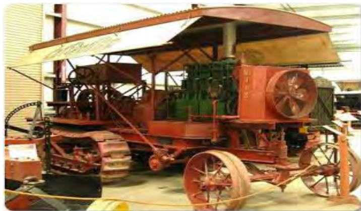
Gambar 2: Contoh bentuk traktor awal mula dengan roda rantai dan sumber tenaga motor bakar internal
