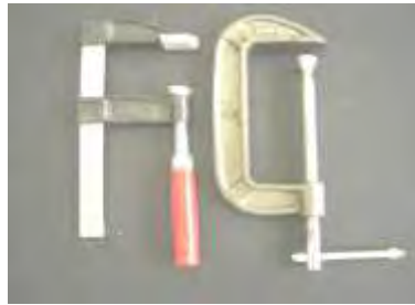
Gambar 1-10. Klem F/G Sumber: Buku Kriya Kayu SMK, Enget dkk
