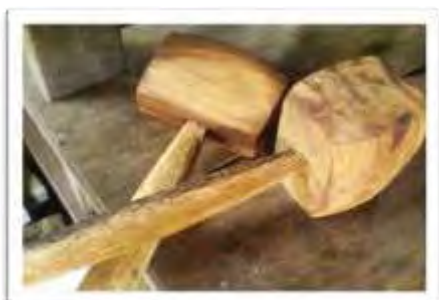
Gambar 1-7. Palu Kayu/Ganden Sumber: Buku Kriya Kayu SMK, Enget dkk
