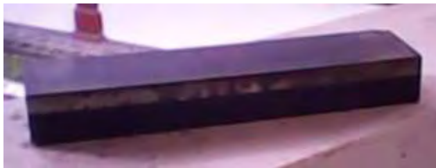
Gambar 2-2. Batu Asah Minyak. Sumber: Buku Kriya Kayu SMK, Enget dkk.
