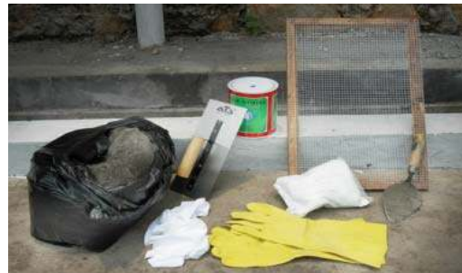
Gambar V-8, Alat dan Bahan Plesteran dengan Sawutan
