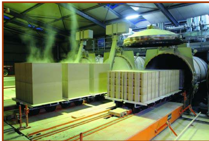
Gambar IV-10. Proses Pembuatan Bata Hebel
