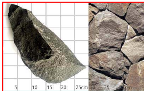
Gambar IV-2, Batu Kali Sebagai Bahan Konstruksi Pondasi Batu Belah
