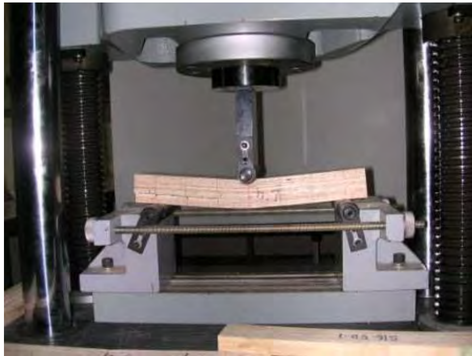
Gambar 44. Aplikasi pengujian lentur pada kayu http://ft.unpar.ac.id/program-studi/teknik-sipil/komunitas-bidang-ilmu/teknik-struktur/laboratorium/
