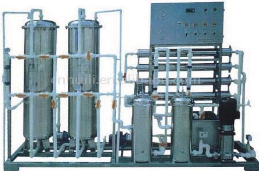
Gambar 5-6. Instalasi Pengolahan Air
