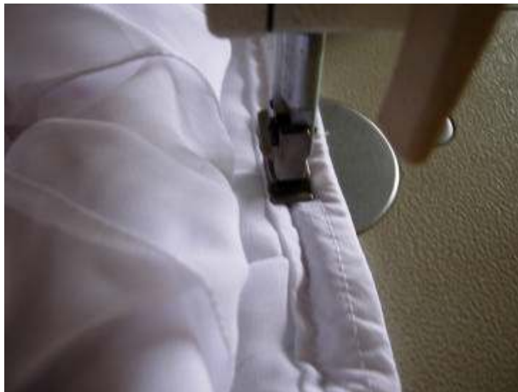
Gb.6. 66 Pemasangan furing
