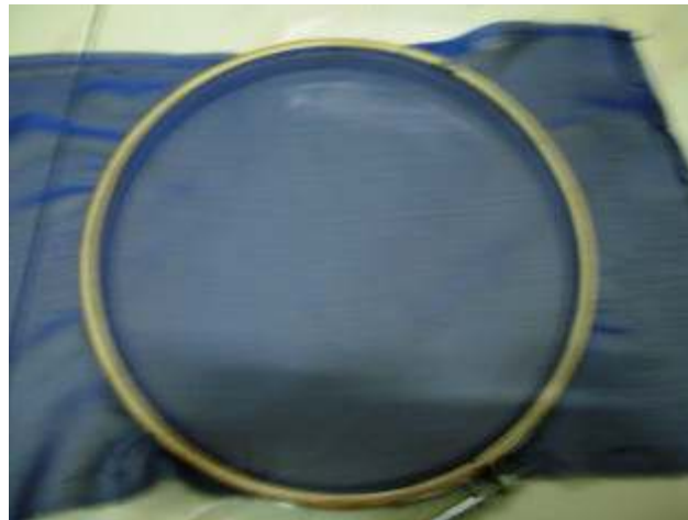
Gb.6. 54 Pemasangan midangan
