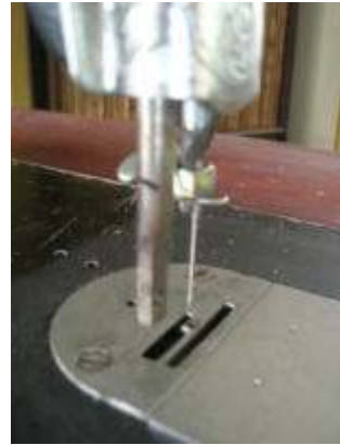
Gb.6. 9 Melepas sepatu mesin jahit dan menurunkan gigi
