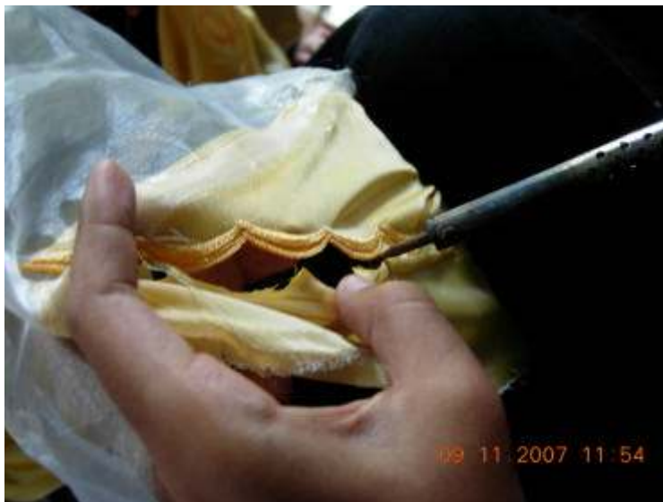
Gb.6. 44 Memotong bagian tepi bordir
