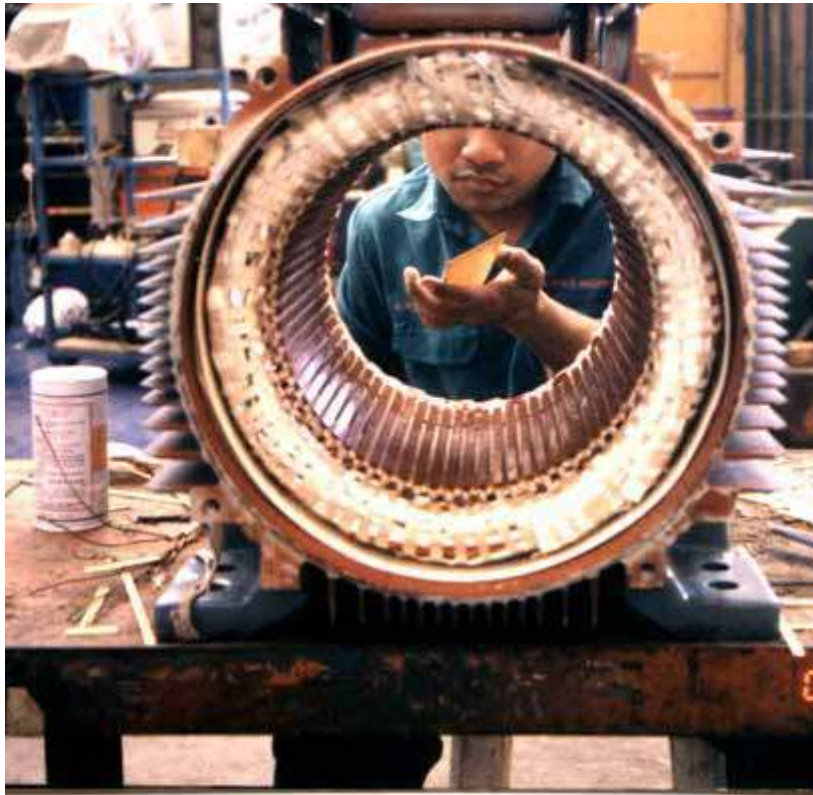
Gambar VI.27 Pemasukan Belitan ke dalam Alur Stator
