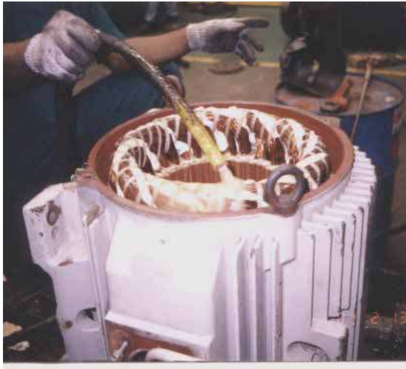
Gambar VI-28 Bentuk Belitan dalam Stator dan Proses Pemvarnisan
